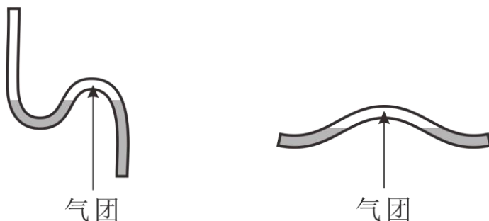
图 4 错误的管道连接图示
